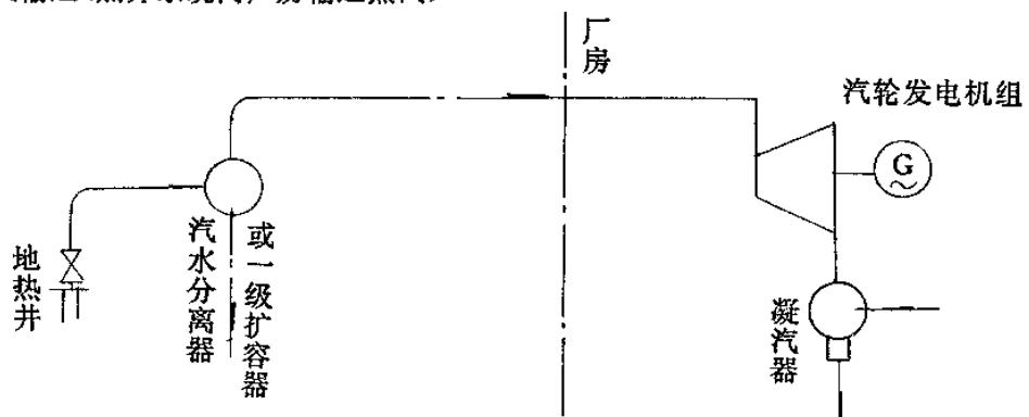
**E1.2 热水或汽水两相混合输送(热井系统向厂房输送热水或汽水混合物)**
