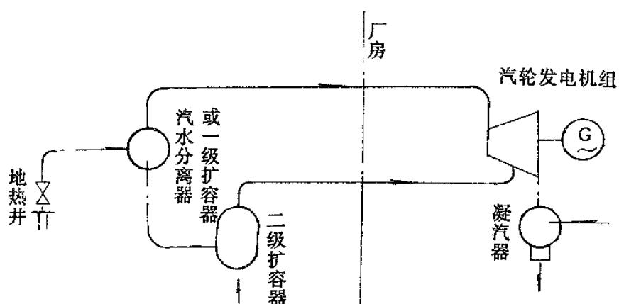
E2.2 蒸汽和热水分别输送(热井系统向厂房输送一次蒸汽，并通过热水泵向厂房内的二级扩容器输送热水)
