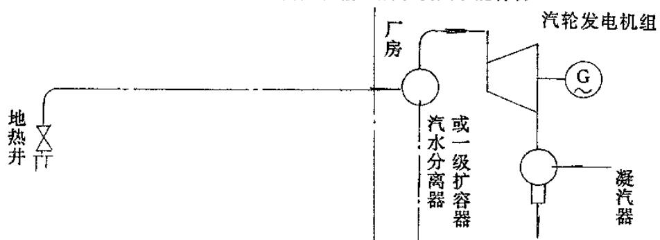
**E2 两级扩容循环系统****E2.1 一、二次蒸汽分别输送(热井系统向厂房分别输送一、二次蒸汽)**
